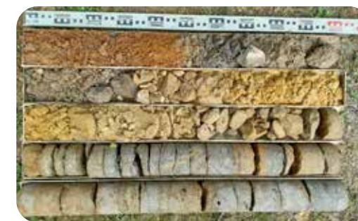
Die Baugrunderkundungen trafen ab ca. 12–13 m Tiefe auf festen Sandstein.
